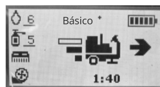
Ejemplo de pantalla: funciones básicas, dosificación, y estado de la batería
