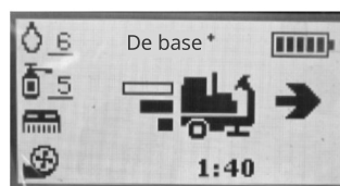
Exemple d'affichage : fonctions de base, dosage, et état de la batterie
