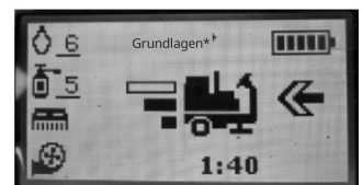
Anzeigebeispiel bei umgekehrter Fahrtrichtung
